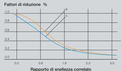
Curve di sollecitazione di instabilità secondo EC3 Parte 1.1. La curva "a" si applica ai profilati cavi finiti a caldo e "c" ai profilati finiti a freddo
